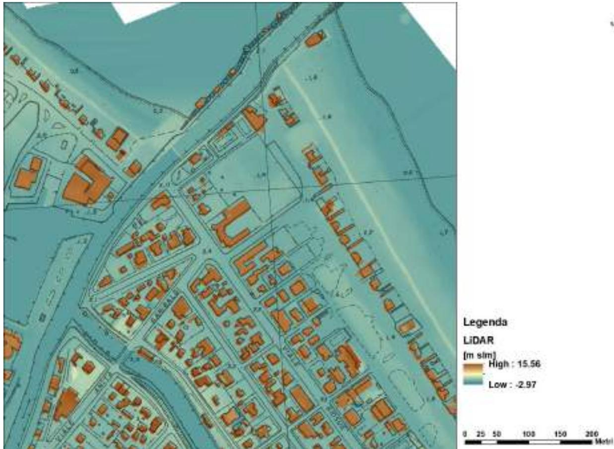
Figura 17 - esempio di rilievo Lidar lungo la costa con edifici estrusi, si nota la presenza della duna invernale
