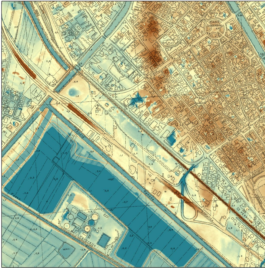
Figura 16 - esempio di DTM lidar a passo 1X 1 m elaborato
